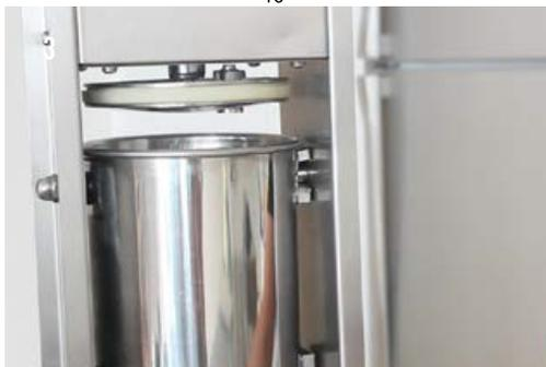
Colocar el cilindro (pieza 5) dentro de la estructura de la máquina. Es importante que las orejas del cilindro topen con la guía para asegurarnos que está colocado correctamente.
