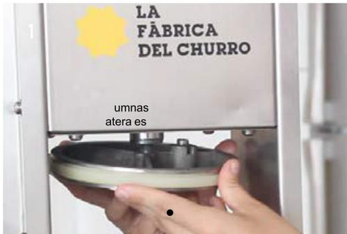
Enroscar la tapa (pieza 2) a la varilla de cuerda (pieza 8) hasta que quede fija.
