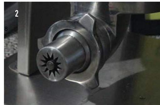
Colocar la boquilla o disco para churros deseado ajustando el anillo que se encuentra a la salida del cilindro.
